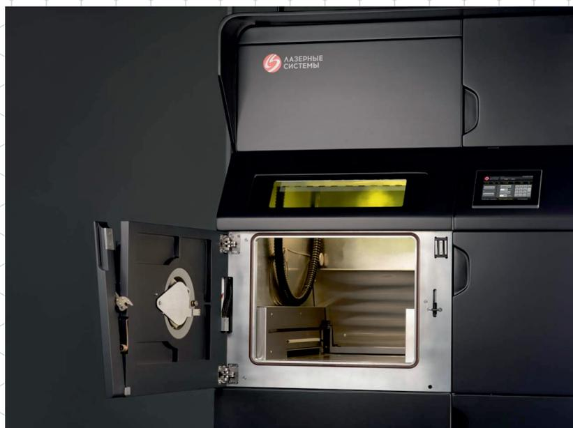
Современные аддитивные установки селективного лазерного сплавления M250 и M350, разработанные и выпускаемые серийно в АО "Лазерные системы", отличаются объемами камер построения и предназначены для выращивания из металлических порошков деталей сложных форм, которые невозможно изготовить с применением традиционных технологий.
