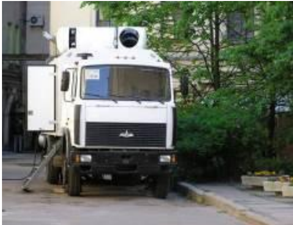
Мобильный лидарный комплекс с двухзеркальной сканирующей системой
