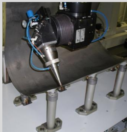
Детали после лазерной размерной обработки: обшивка и носок
