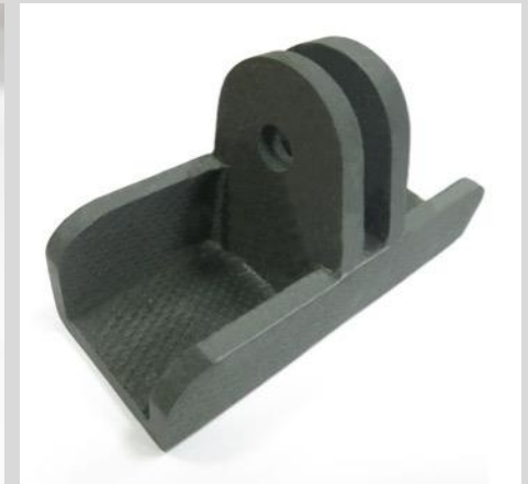
Узел крепления после мехобработки
